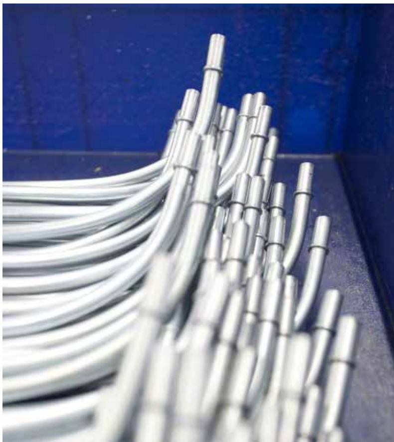
Diese bereits bearbeiteten Rohre werden für die Montage von Schiebedächern in Pkw verwendet.
